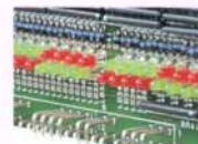
●すばやい故障診断を可能にした多重伝送入出力ランプ表示。
